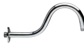
Braccio doccia in ottone cromato con rosetta 1/2Mx1/2M lunghezza cm 30. CP brass shower arm, with wall flange 1/2Mx1/2M length cm 30.
